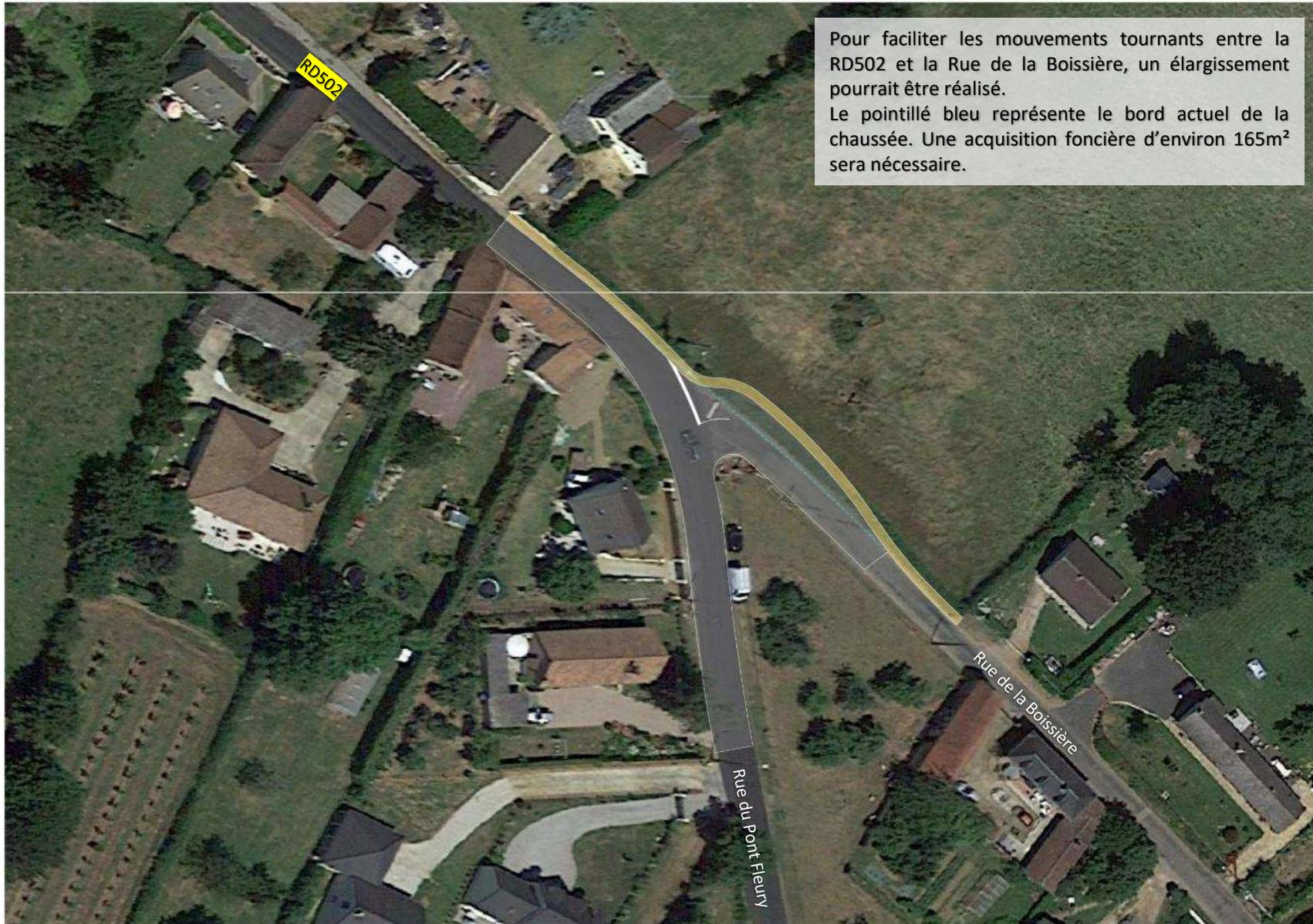
Pour faciliter les mouvements tournants entre la RD502 et la Rue de la Boissière, un élargissement pourrait être réalisé.
